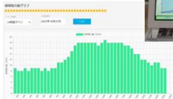
電力使用状況グラフ（デマンド）
